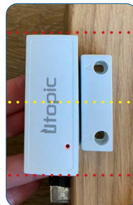
Modul a magnet musí být montovány na osu středu!
